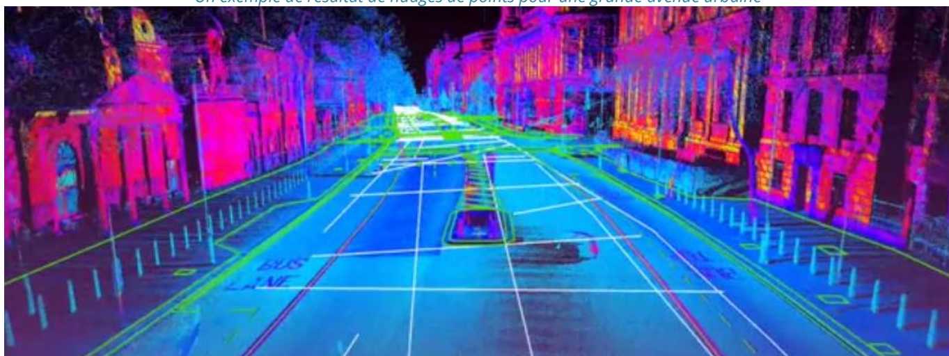
Un exemple de résultat de nuages de points pour une grande avenue urbaine
