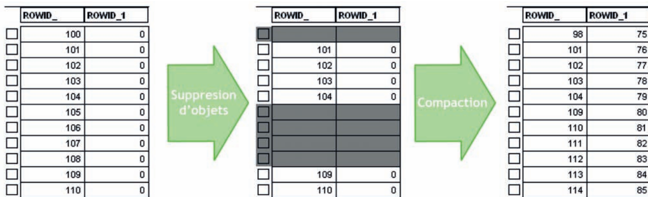
Figure 6 - Evolution du ROWID lors de la suppression d'objet
