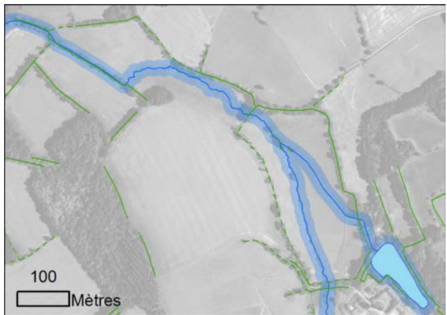
Figure 8 - Zone tampon autour du réseau hydrographique
