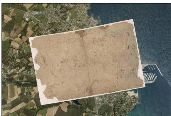
Géoréférencement d'une feuille cadastrale puis superposition sur un fond d'orthophotographie (GéoBretagne). Effectué avec l'image brute, puis avec l'image détourée. On voit ici l'intérêt du détourage réalisé précédemment. Commune de Saint-Quay Portrieux - Côtes d'Armor
