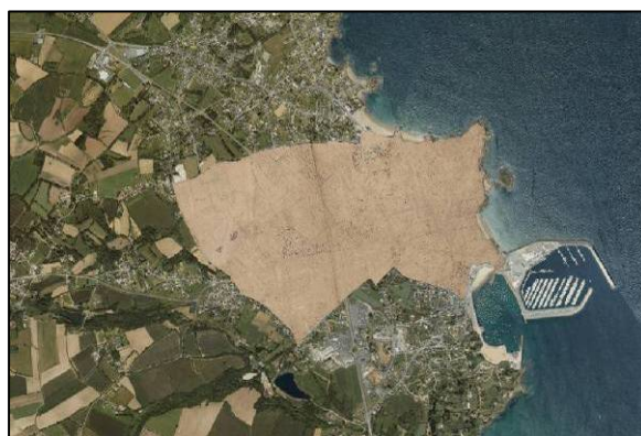
Géoréférencement d'une feuille cadastrale puis superposition sur un fond d'orthophotographie (GéoBretagne). Effectué avec l'image brute, puis avec l'image détourée. On voit ici l'intérêt du détourage réalisé précédemment. Commune de Saint-Quay Portrieux - Côtes d'Armor
